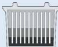
BEZ CARBON BOOST® Kyselina sírová klesne ke dnu článku baterie
